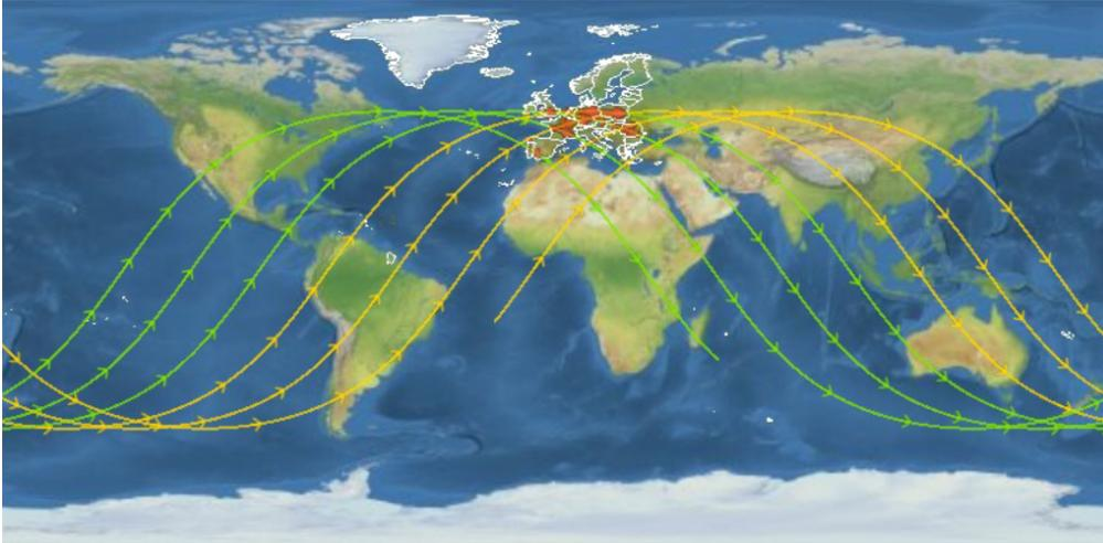
وطبقا للحسابات الفلكية فان الشكل المرفق يوضح المسار الارضى للمركبة الفضائية وموقع سقوطه المحتمل عند خط عرض  $18^{\circ}21'39.96''N$  وخط طول  $59^{\circ}53'14.64''W$
